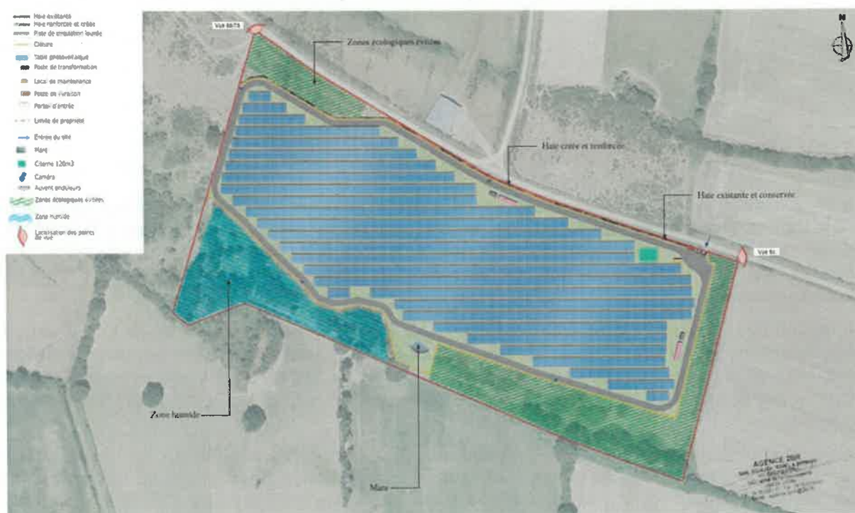
Illustration 3 : Schéma d'implantation de la centrale (source : dossier)
