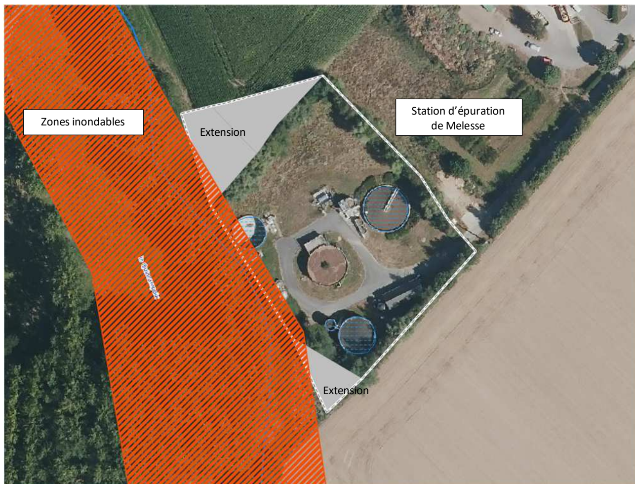
Figure 26 : Zones inondables du Quincampoix à proximité de la station d'épuration de Melesse
